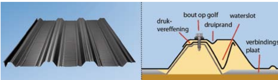
Afb. 5.16 Plannja 40 systeem voor daken met een hellingshoek tussen 3 en 6 graden. Bron: www.plannja.se
