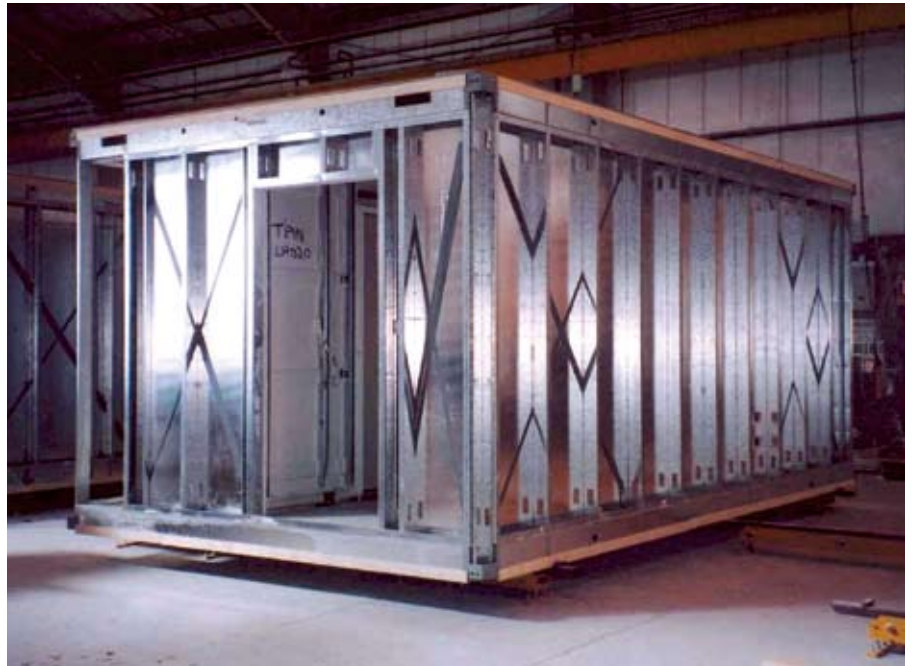
Afb. 6.2 Module met dragende wanden. Bron: Terrapin.
