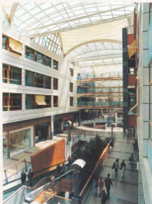
Grote openbare gebouwen kunnen worden ontworpen met 'fire engineering'. Dit kan bijvoorbeeld betekenen dat het staal onbeschermde blijft in grote, open ruimten.
